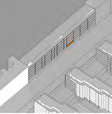
06:35 Hela fasader väster om Sten Sturegatan skuggas av bebyggelsen öster om Sten Sturegatan.
