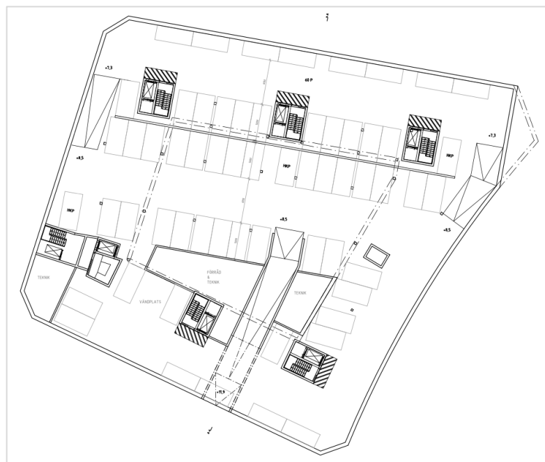
Bild 11: Garaget under byggnadskroppen, med ca. 60 bilplatser. Bild: Okidoki arkitekter
