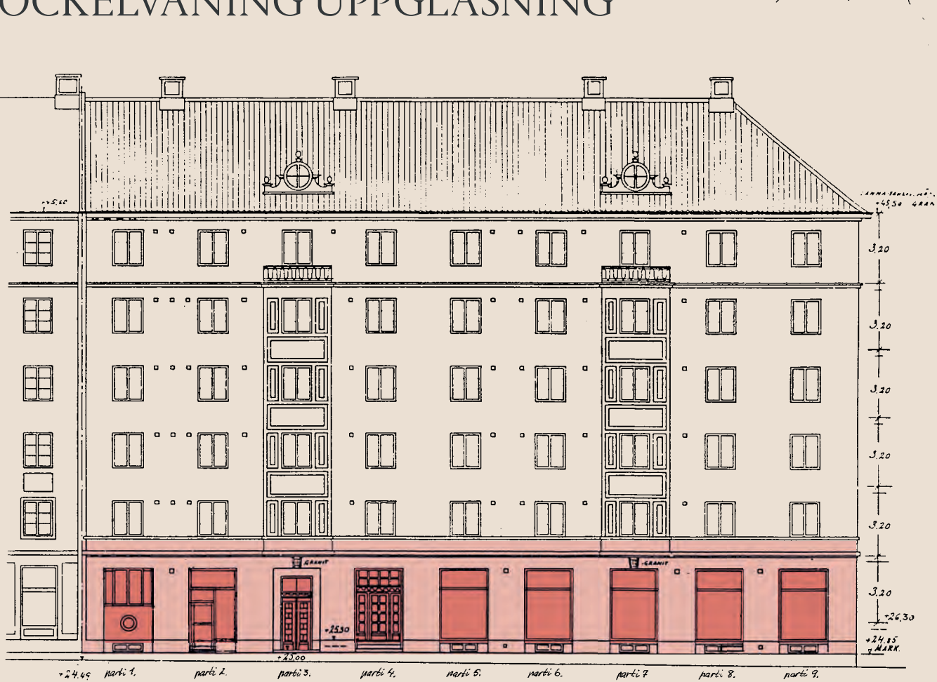
LINNÉGATAN Uppglasning (=hål i mur) längd/fasad: ca 53,6%
