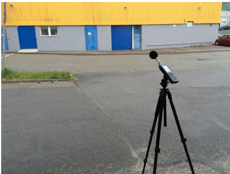
Figur 11. Mätposition 3 - ventilationsutblås vid Pägens fryslager
