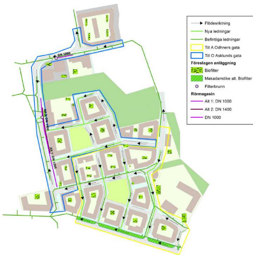
Figur 23. Översiktlig illustration av föreslagna dagvattenanläggningar, ytavrinningsvägar och anslutningar till befintligt ledningsnät. Blått område visar område som avvattnas till rörmagasin längs med Olof Asklunds gata, medan gult område visar område som avvattnas till trädstråk med skelettjord längs med A Odhners gata. Nya ledningar har föreslagits och ritats in specifikt för vägdagvatten, medan dagvatten från kvartersmark föreslås ledas i separata ledningar för att inte belasta anläggningarna för vägdagvattnet. (Berggren-Clausen 2017)
