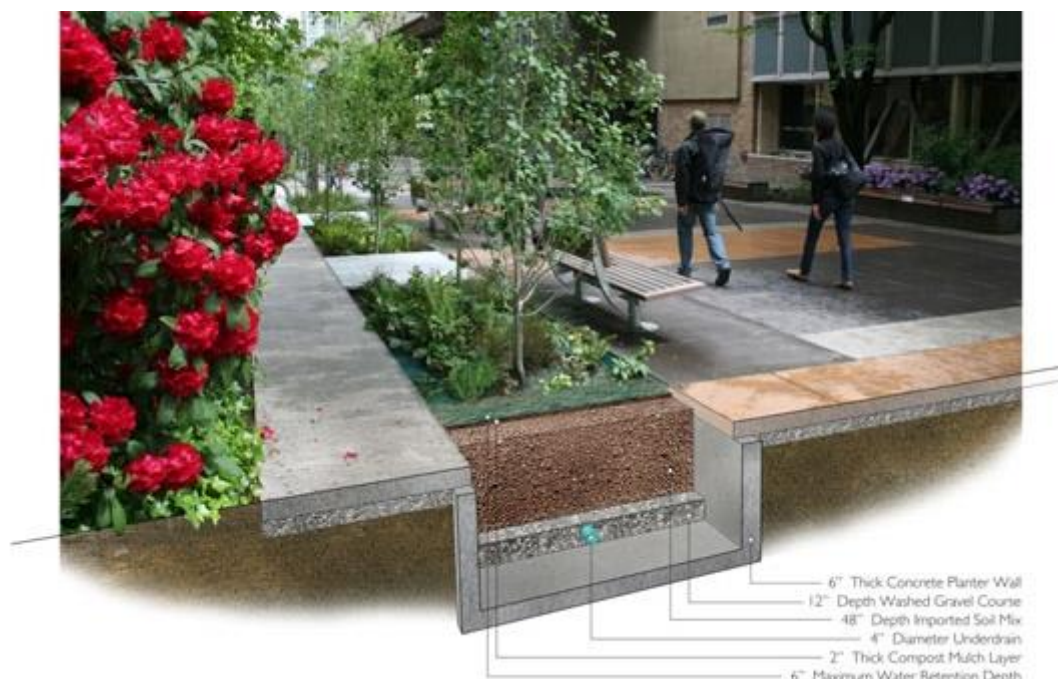
Figur 25: Exempel på utformning av ett biofilter på kvartersmark som visar hur anläggningen kan delas upp i mindre delanläggningar och integreras med grönytor (Vegtech, 2016).
