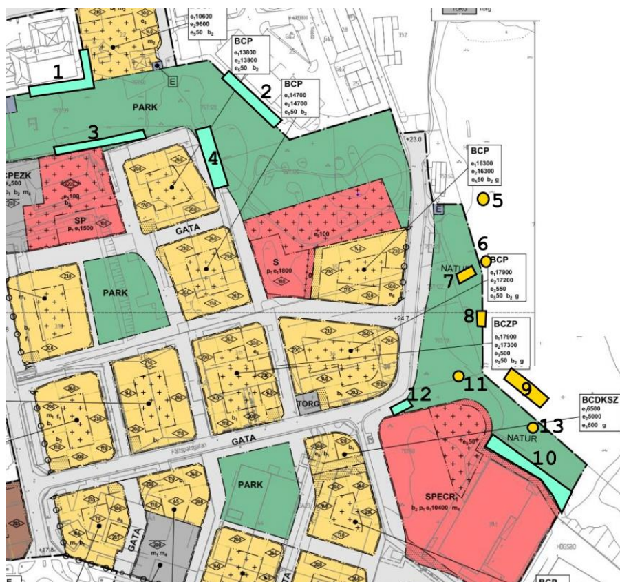
Figur 3. I området förekommer 13 st. slänter med behov av åtgärder för att säkerställa bergstabiliteten. Blågröna markeringar är sprängda bergslänter, gula markeringar är naturliga slänter eller naturliga ostabila block.
