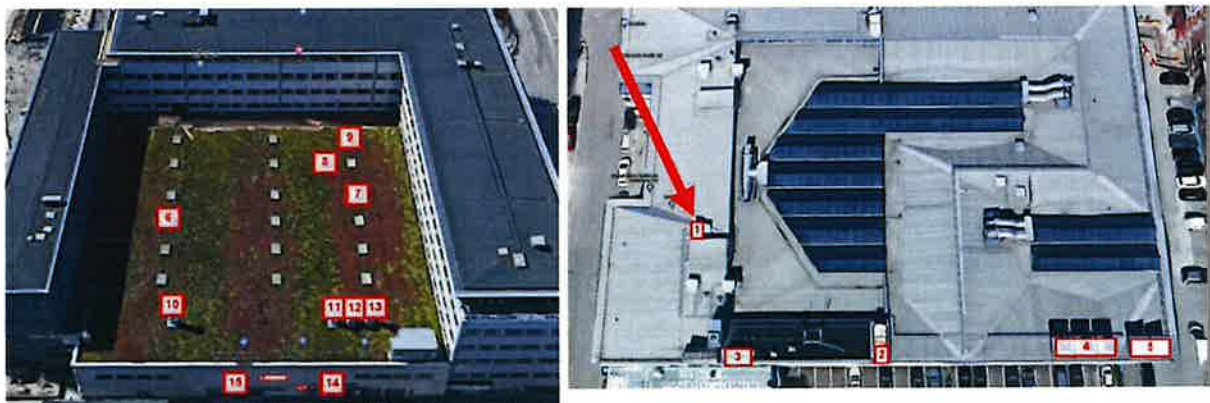
Figur 42 visar bullerkällor (fläktar på tak) på intilliggande fastigheter. Bilden t v visar källor för Gullbergsvass 4:2 väster om planområdet. Bilden t h visar källor för Gullbergsvass 5:26 norr om planområdet. Den röda pilen visar källa 1, som definierats som den dimensionerande källan av alla källor.
