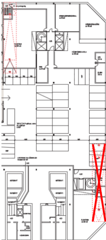
Figur 6. Förkastat alternativ med utfart sydost om byggnaden.
