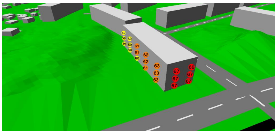
Figur 19: Ekvivalent ljudnivå på fastigheten Guldheden 17:1 utan planförslag.
