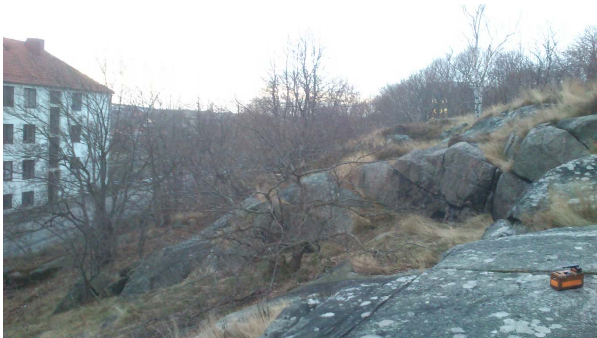
Foto 5. Delområde 3, ungefär mitt i området. Bilden är tagen mot norr. Sprickor i sprickgrupp 1 definierar slänterna som idag är stabila.
