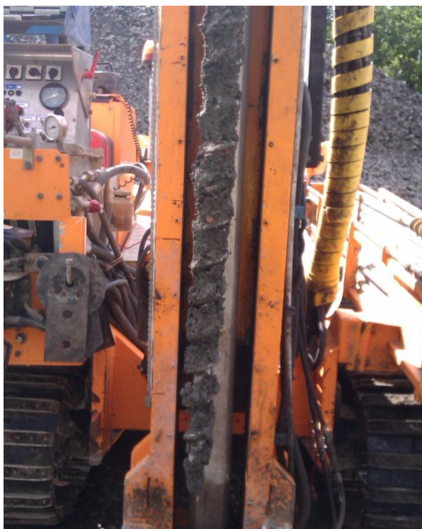
Figur 6. Skruvprovtagning i fyllnadsmassor i punkt 3.
