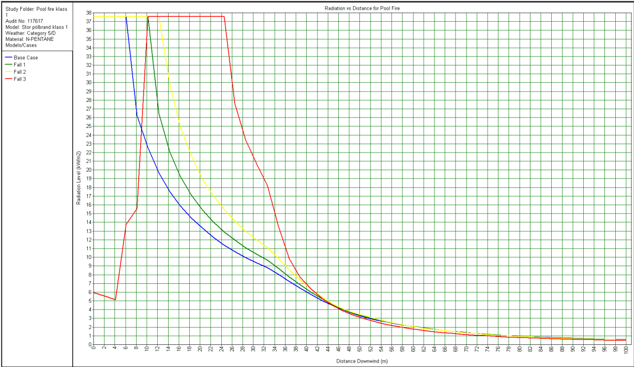
Figur B.5. Strålningsnivå i kW/m² på olika höjd över mark som funktion av avstånd. Brandscenario; pölbrand 200 m², bensin, vind 5 m/s. De olika fallen beskriver strålningen på olika höjd över marken (Base Case= 0 m, Fall 1=2 m, Fall 2=5 m och Fall 3=15 m). Not: Avstånd (x-axel) räknas från centrum av pöl
