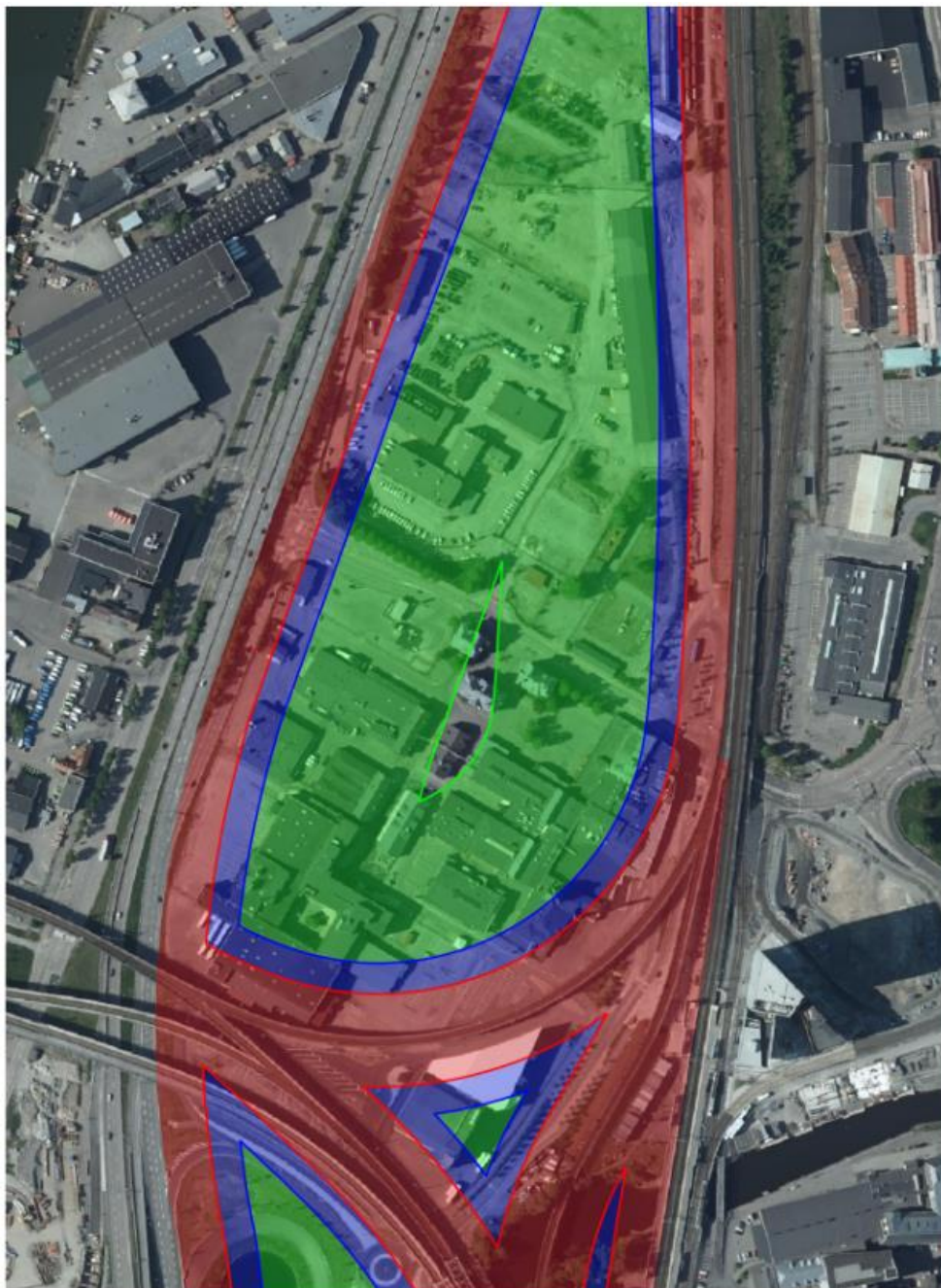
Figur 21. Zonindelning av föreslagna skyddsåtgärder. Röd zon anger 0-30 meter, blå zon anger 30-50 meter och grön zon anger 50-150 meter från studerade farligt godsleder. Notera att skyddsåtgärd som rekommenderats 0-50 meter från farligt godsled därmed gäller i både röd och blå zon i figuren ovan.
