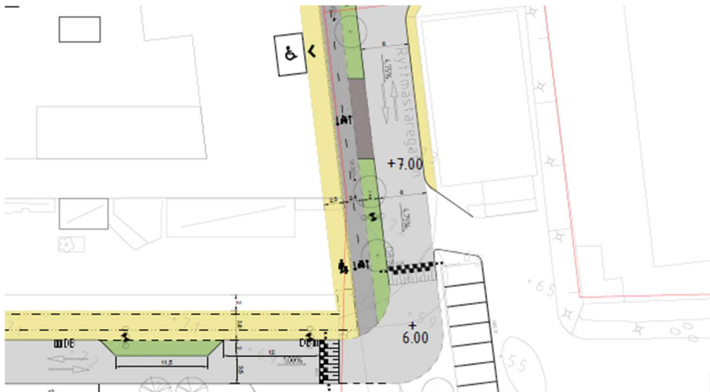
Figur 37. Del av Kullagergatan mellan Sven Wingquists gata och Ryttmästaregatan med kurvan mot Ryttmästaregatan med husets hörn som möjligen kan fasas in. (Se bifogad ritning 0215 - 18)
