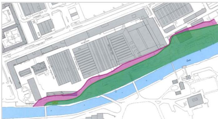
Säkerheten mot skred vid åravinen är otillfredsställande. Områden med lägre säkerhetsfaktor än 1,3 (grön) och lägre än 1,4 (röd).
