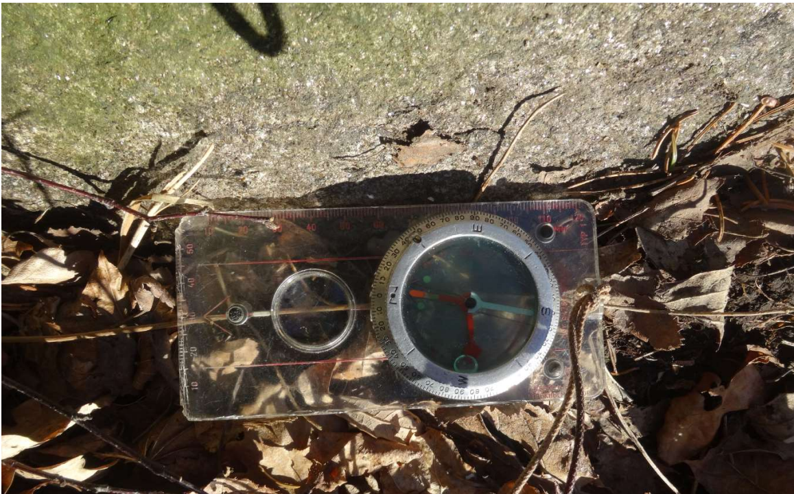
Bild 4 där kompassen har lagts med samma riktning som foliationen N10^{\circ}W och lutningen var ca 70^{\circ} grader mot väster. Generellt varierar lutningen på sprickorna som skapats av foliationen mellan ca 45^{\circ} - 70^{\circ} grader.
