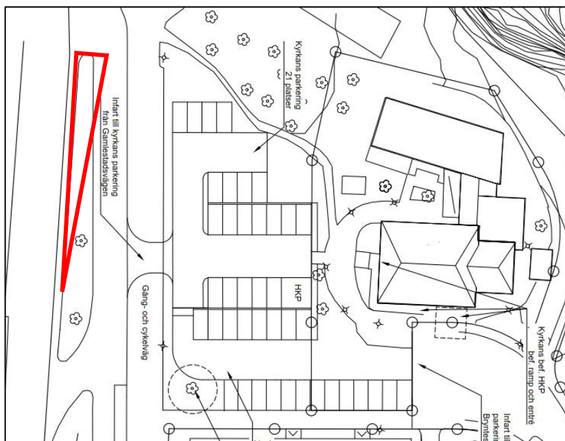
Figur 11: Ungefär erforderlig sikttriangel illustrerad över ritningen med föreslagen utformning. På grundkartan visas bara två träd där det i verkligheten finns tre träd.
