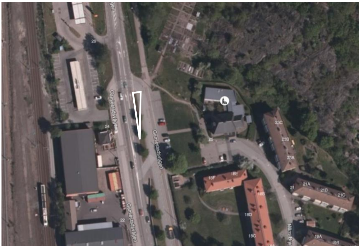
Figur 10: Korsningen mellan Gamlestadsvägen och lokalkörbanorna på var sida om Gamlestadsvägen strax norr om Nylöse kyrka. Ungefär den sikttriangel som krävs enligt tekniskhandbok illustreras med vit linje. (Satellitfoto från Hitta.se)
