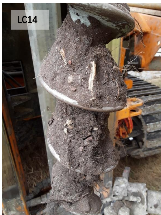
Figur 10. Exempel på sandig, grusig mulljord vid gräs- och kullerstensytorna framför kontorsbyggnaden.
