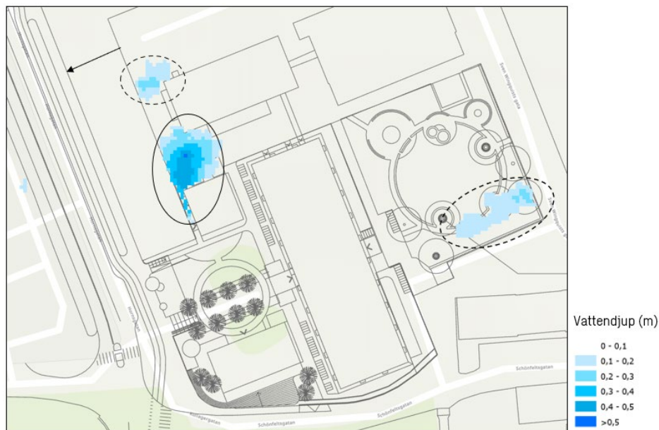
Figur 6. Översvämmade ytor vid framtida markanvändning. Inringat i svart återfinns lågpunkt med ansamlat vatten om 70 m 3 (SCALGO Live). Markerat inom streckade linjer finns vattenansamlingar som är av mindre omfattning. Vattendjup under 10 cm visas inte i figuren.
