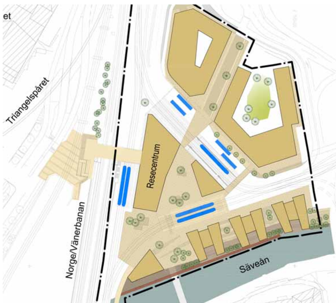
Torgmiljön med hållplatsområden redovisade. Vita ytor utgör trafikseparerade ytor för kollektivtrafik och fordonstrafik, gulfärgade ytor är planerade för blandtrafik/torgyta. Illustration: White arkitekter
