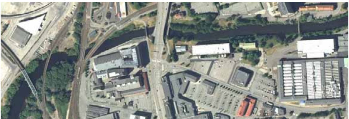
Ortofoto över Säveån från 2008. Viadukten för Gamlestadsvägen passerar över ån mitt i bild. Från viadukten och västerut är strandskyddet upphävt och sträckan utgörs av makadamslänter samt en knappt en meter hög stödmur med ca 60 m delvis överhängande grönska. Sträckan öster om viadukten omfattar en tät vegetationsbård på båda sidor om ån av stort naturvärde.
