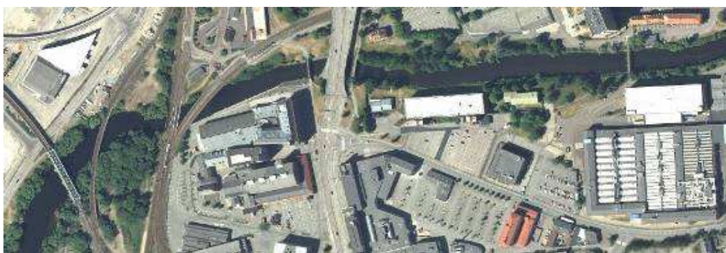
Ortofoto över Säveån, 2008. Viadukten för Gamlestadsvägen passerar över ån mitt i bild. Från viadukten och västerut är strandskyddet upphävt och sträckan utgörs av makadam-slänter samt en knappt 1 meter hög stödmur/kaj med ca 60 m överhängande grönska. Delarna öster om viadukten omfattar en tät vegetationsbård på båda sidor om ån.
