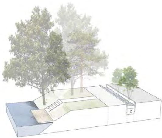
PRINCIPSEKTION - TRAPPA TILL VATTENNIVÅN
