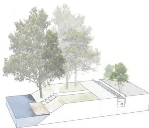
PRINCIPSEKTION - TRAPPA TILL VATTENNIVÅN
