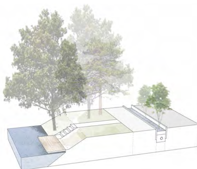
PRINCIPSEKTION - TRAPPA TILL VATTENNIVÅN
