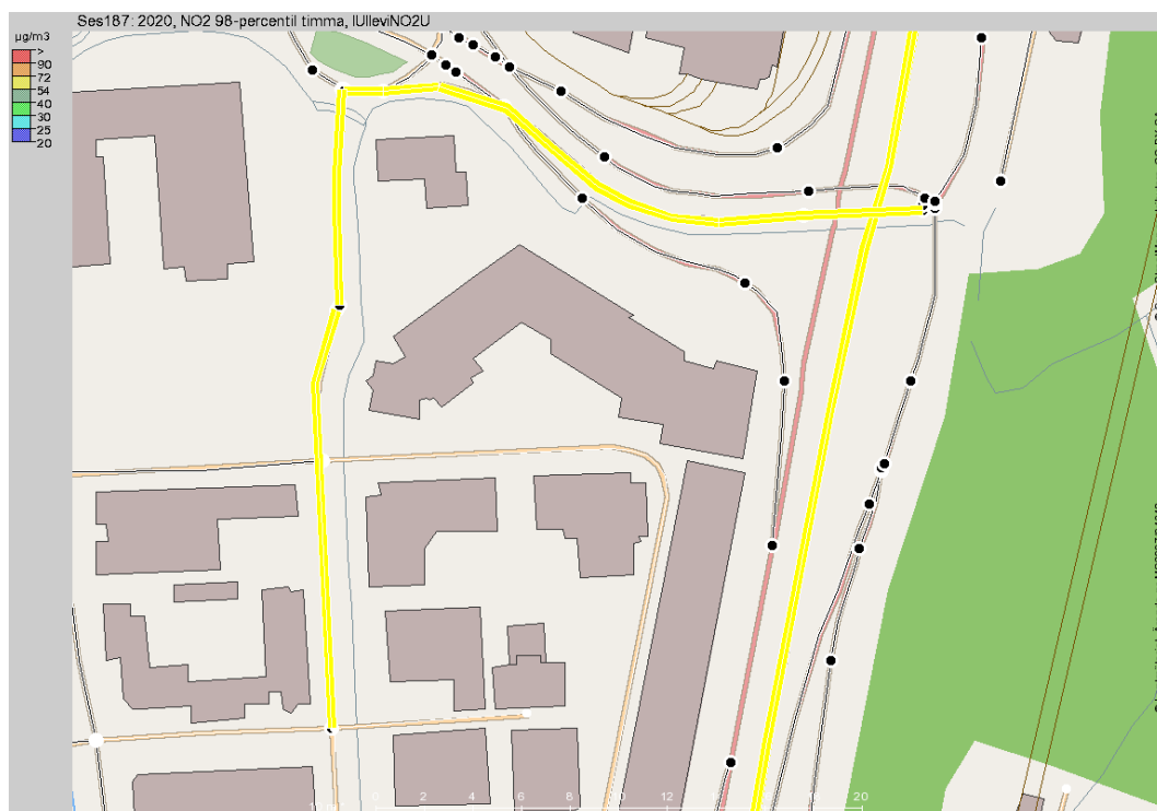
Figur 22. Framtidsscenario 2020 beräknade halter av kvävedioxid som timmedelvärde (98-percentil), innan genomförande av detaljplanen, 2 m från fasad och 2 m ovan mark.
