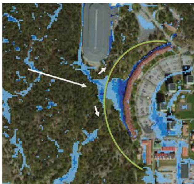
Figur 38 Exempel på skyfallsåtgärd avskärande dike.
