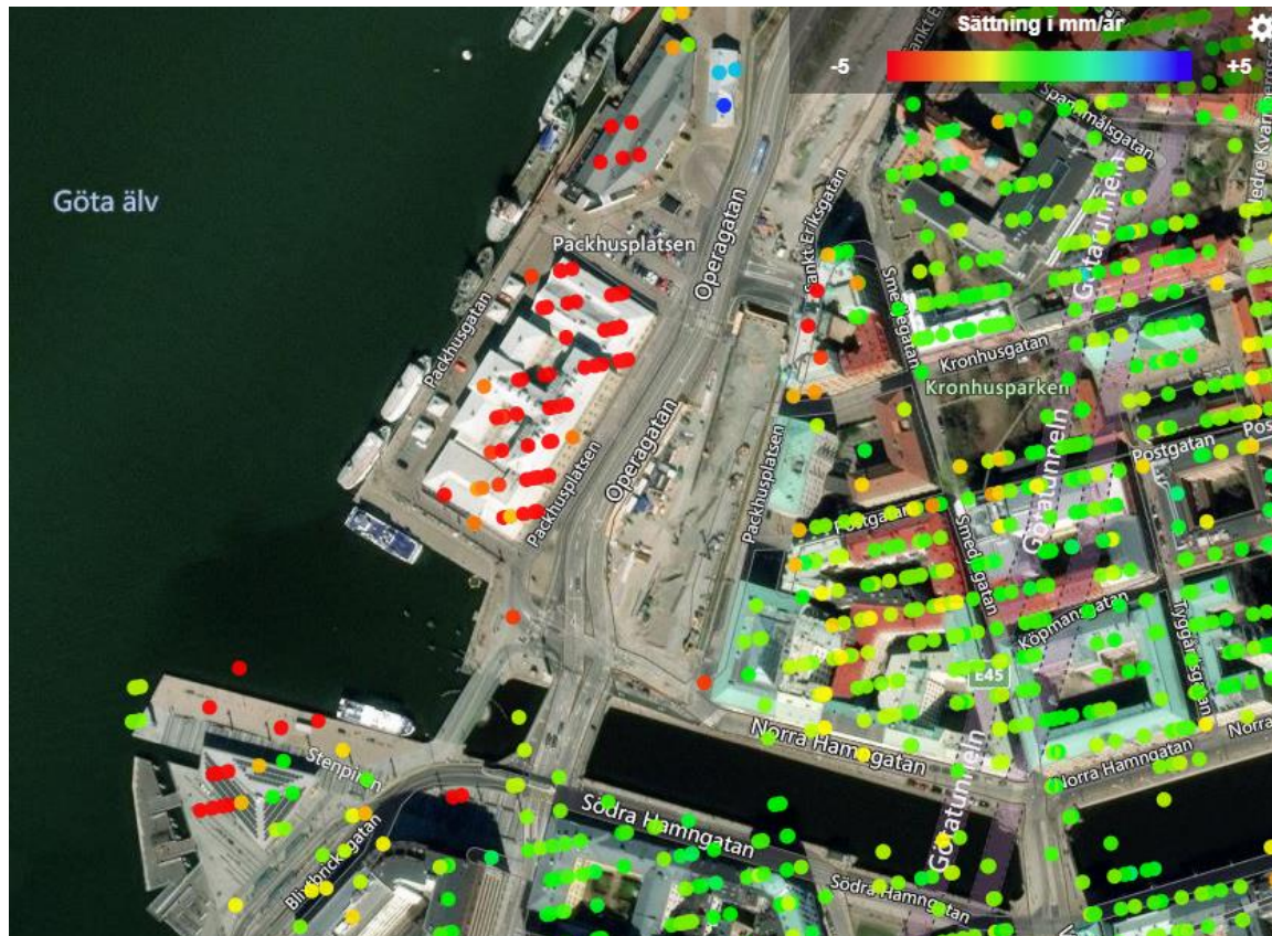
Figur 16. Kartbild med färgkodade punkter visande pågående sättningar inom Packhuskajen, skala från -5 till +5 mm/år. Den beräknande rörelsehastigheten baseras på punkternas rörelser under perioden mars 2017 till mars 2021. Hämtad från sättningskartan 2023-09-11.
