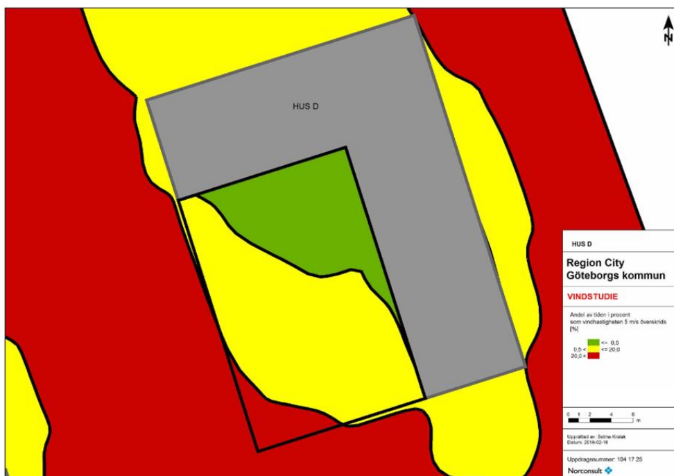
Figur 5.13. Vindförhållanden på takterrassen på torn D.
