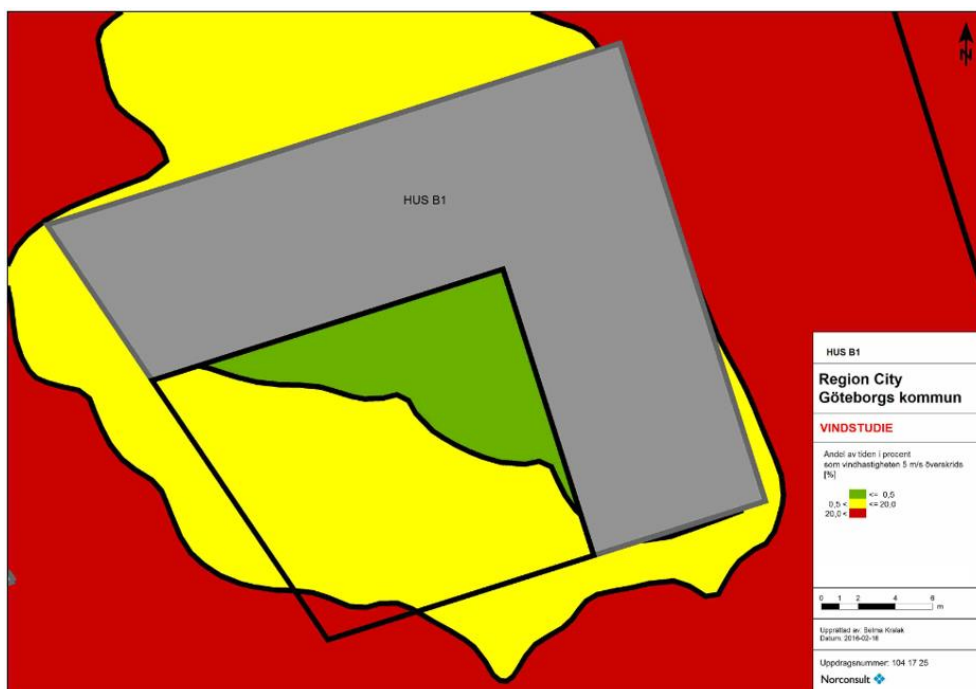
Figur 5.10. Vindförhållanden på takterrassen på torn B1.
