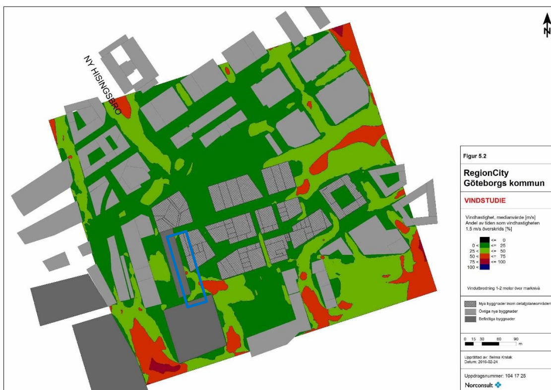
Figur 5.2. Medianen av vindhastighet över 1,5 m/s. Medianen (50 %) överskrids inte i de gröna områdena. Dessa är lämpliga för långvarig vistelse. Röda områden är mindre lämpliga för detta.
