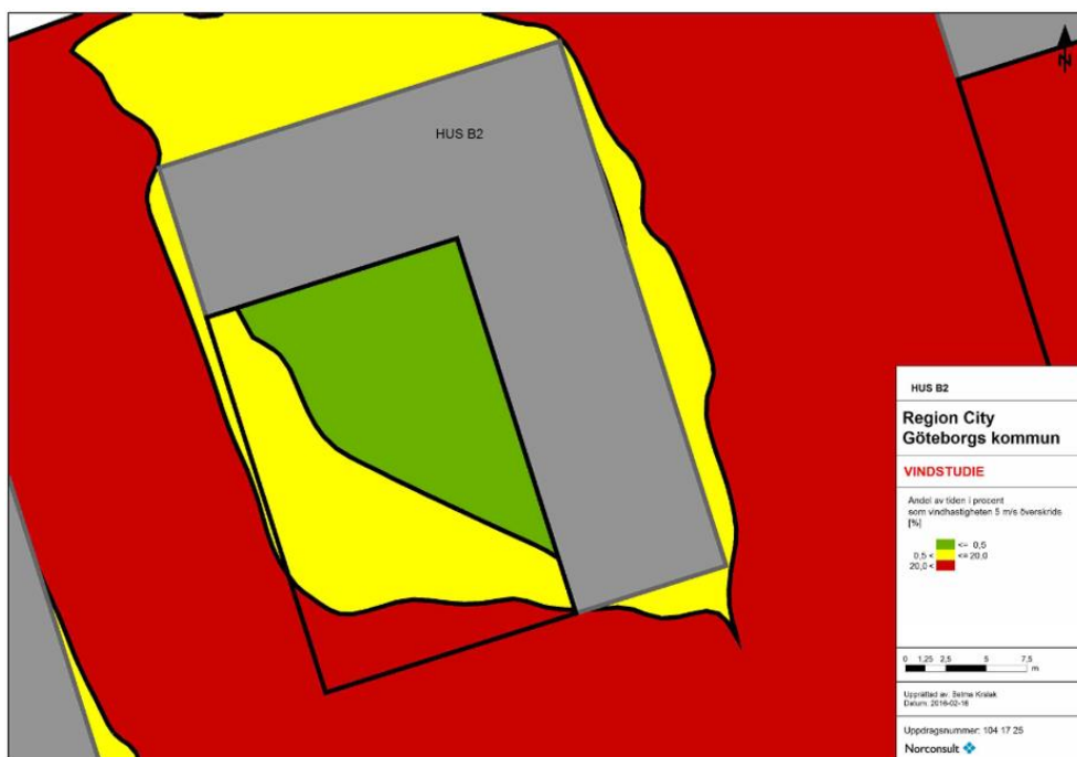
Figur 5.11. Vindförhållanden på takterrassen på torn B2.
