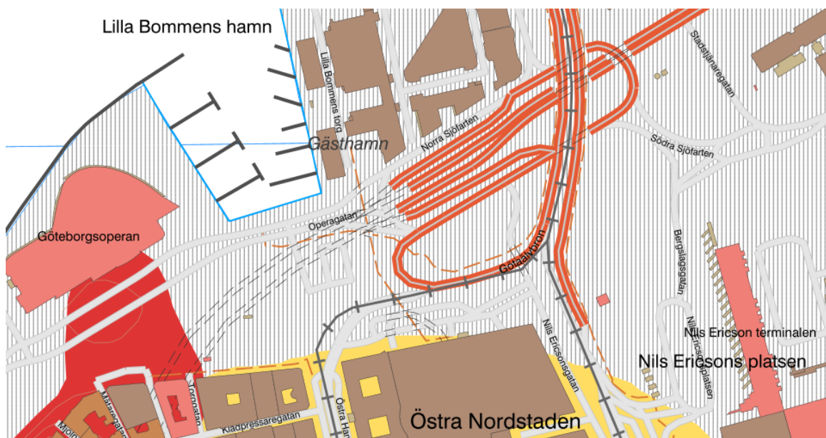
Figur 6 Jordartskarta (övre lager) 1:25000-1:100000, SGU/ Rött - urberg / senapsfärgat - postglacial sand /gult - Postglacial lera/ skrafferat - fyllning normalt 2-3 meter som mest 6 meter.
