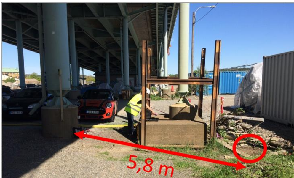
Figur 17 Placering givare på pelarsockel samt i mark
