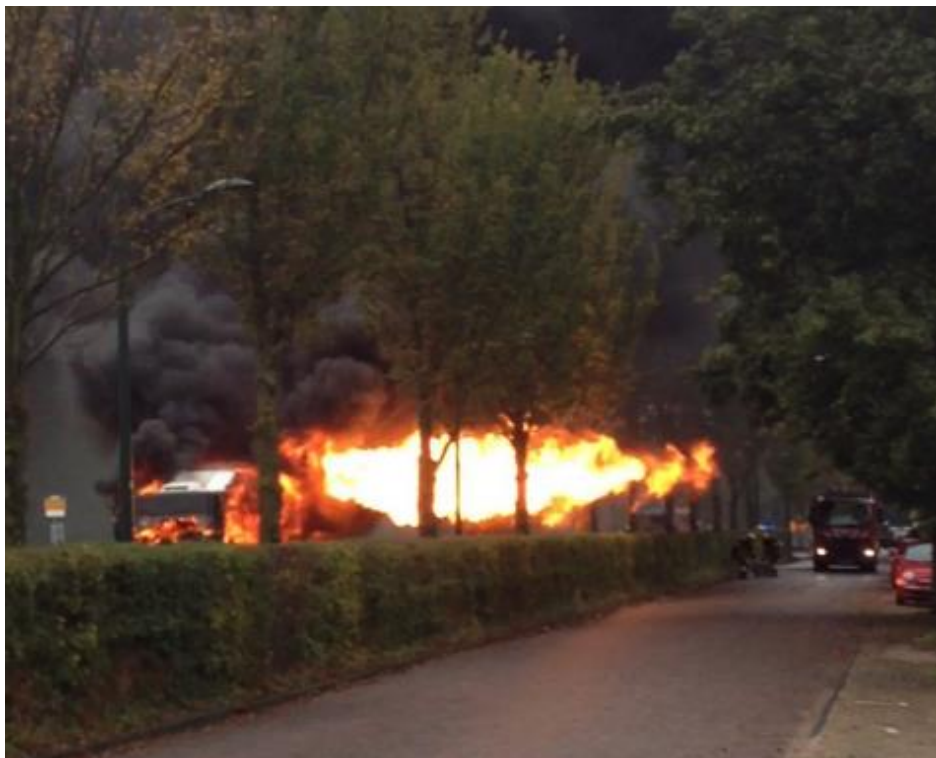
Figur 2-4 Jetflamma från gasbuss i Wassenaar, Holland, 19 oktober 2012. Källa: Dutch Safety Board (2013). Då smältsäkringens gick uppstod en jetflamma på 15-20 meter som pågick under fyra minuter.
