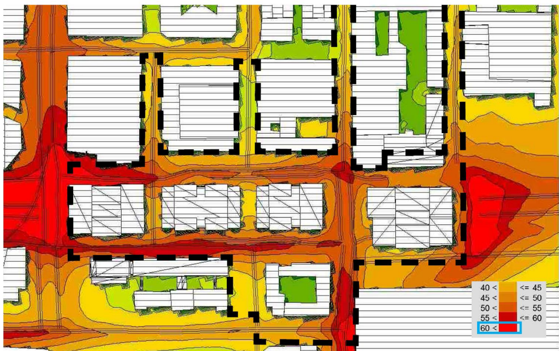
Figur 40. Karta visar luftsituationen vid utbyggnadsalternativet 2026, dygn: NO2 98-percentil. Gränsvärdet för MKN visas med blå ruta. Detaljplaneområdet visas med svart streckad linje. Källa: COWI, juni 2016
