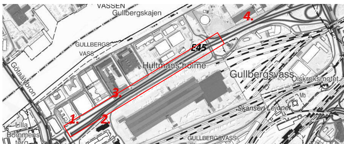
Figur 9. Numreringarna visar utförda vibrationsmätningar, punkt ett och tre angränsar närmast det aktuella planområdet. Källa: Tyréns AB för Trafikverket
