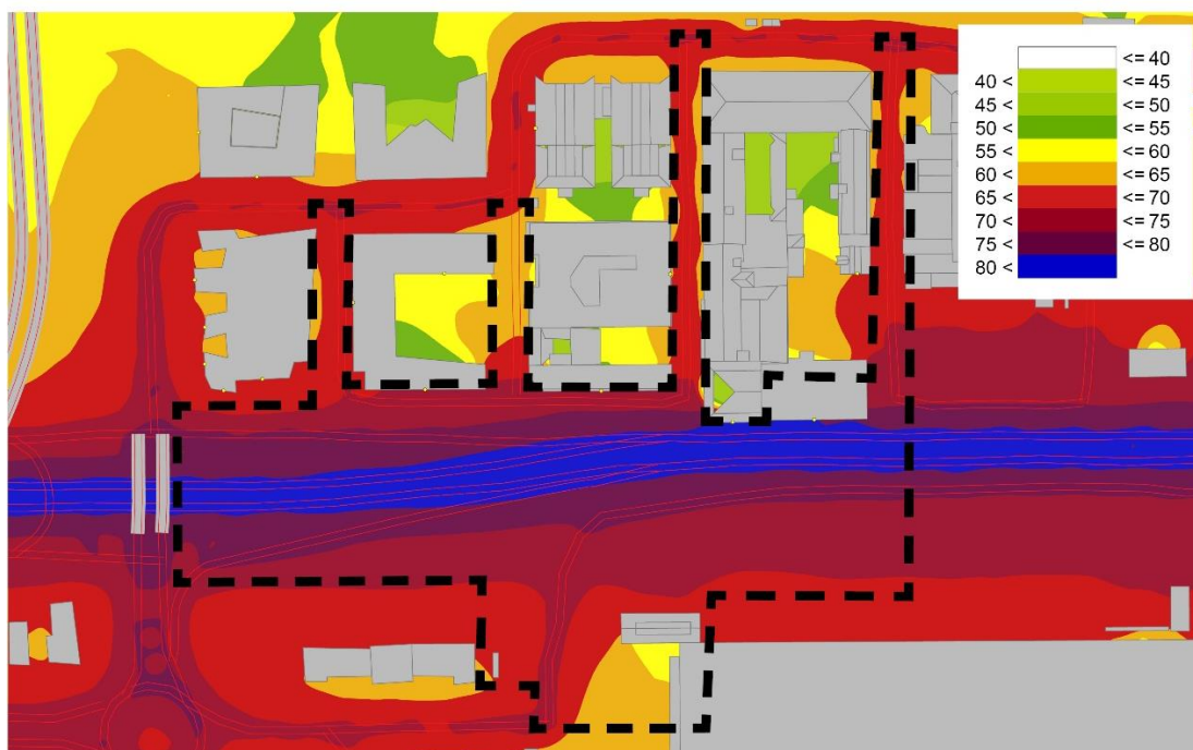
Figur 8. Kartan visar trafikbullernivåerna för planområdet 2016. Källa: COWI, juni 2016. Planområdet är markerat med svart streckad linje.
