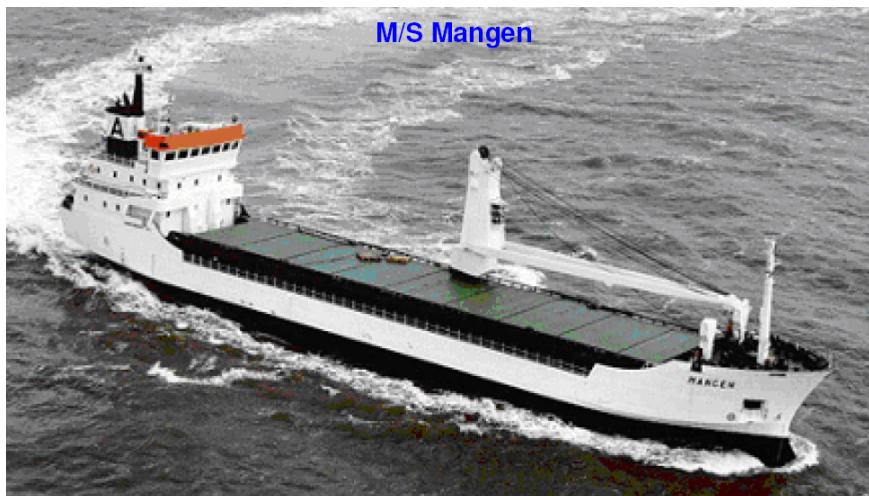
Vänermaxfartyg M/S Mangel L= 89 m. B= 13,2 m. Djupgående = 5,4 m. Masthöjd 26 m
