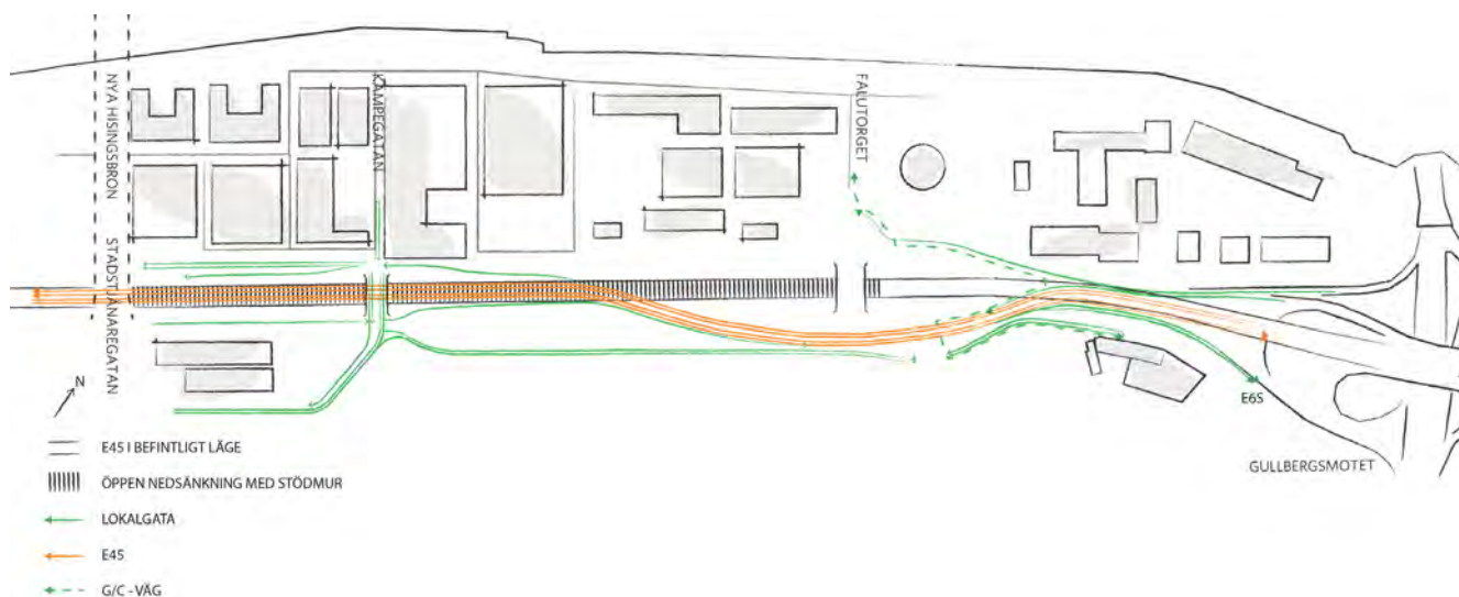
Figur 3.18. Etapp 2 i utbyggnaden, östra delen av E45 byggs ut och trafiken leds om söder om befintlig E45.
