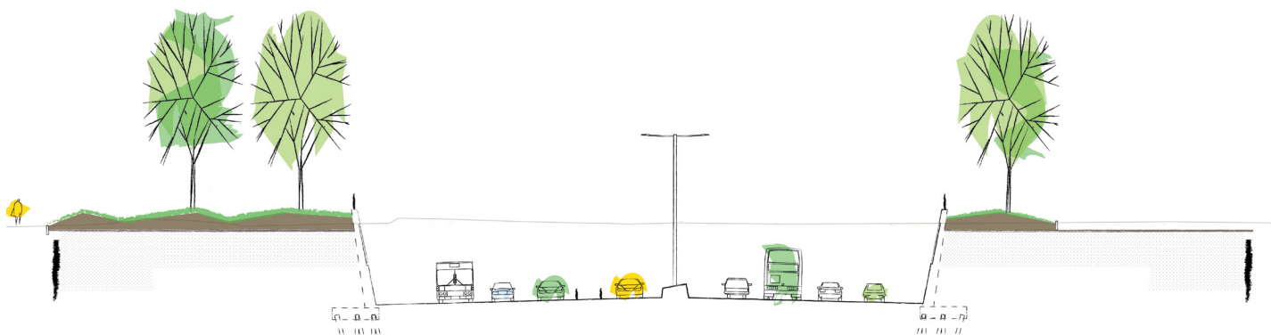
Figur 17. Sektion av en nedsänkt väg E45 med befintlig marknivå illustrerad som en tunn heldragen linje över nedsänkningen.
