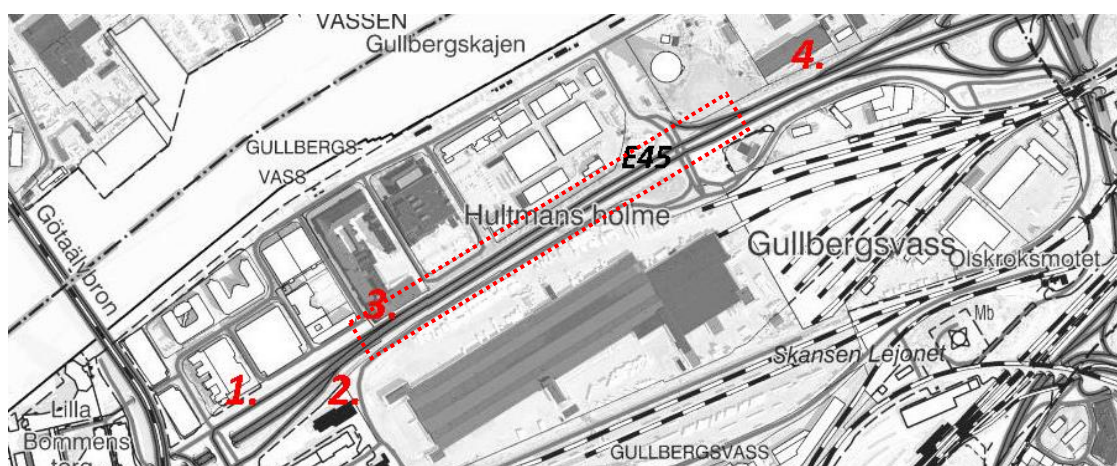
Figur 10, numreringarna visar utförda vibrationsmätningar, punkt tre angränsar närmast planområdet. Planområdet är ungefärligt illustrerat med streckad linje (av Tyréns AB för Trafikverket).
