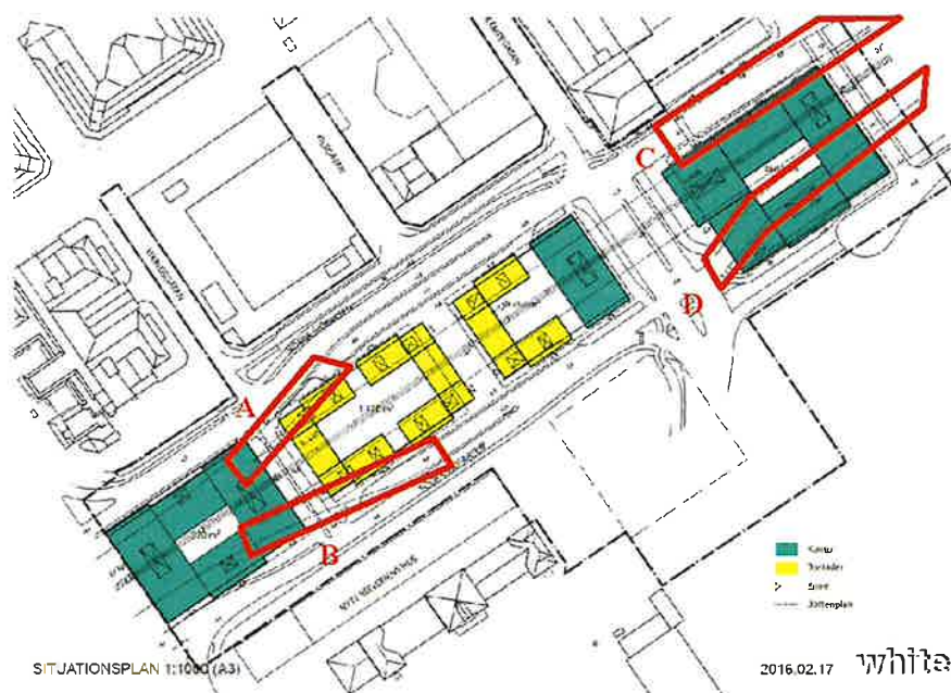
Figur 33. Karta över de olika rampernas lägen som leder trafik på och av Götaleden, upp och ner i tunneln. De röda markeringarna visar de delar av ramperna som ligger under mark eller är utformade som tunnel. Ramp A och B fortsätter enligt bilden ytterligare mot öster (förbi de två mittersta kvarteren), men här är ramperna bara nedsänkta i marken utan tak. Källa: COWI Kvalitativ riskutredning 2017
