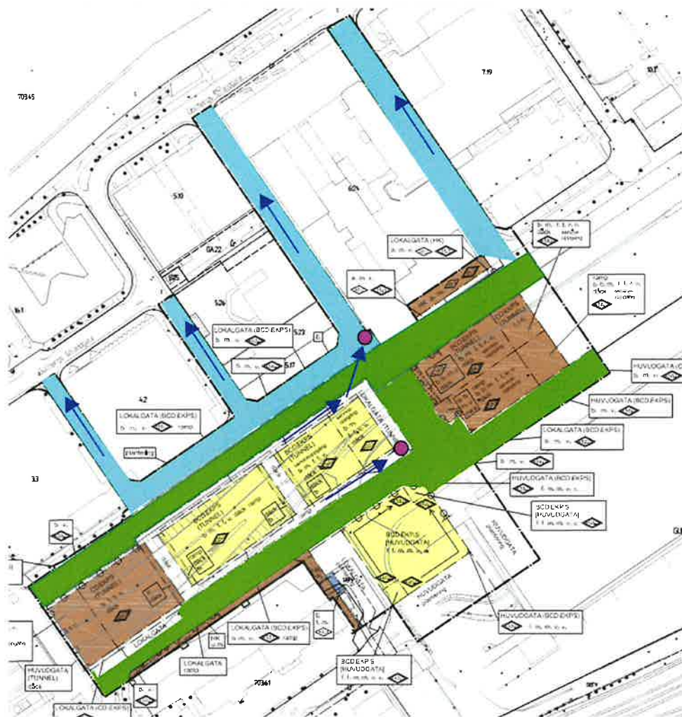
Figur 29. De norra gatorna (markerat med turkos) avrinner via befintligt system till Göta Älv efter att ha renats. Ljusgrönt område avleds till Trafikverkets system som renar dagvattnet. Lokalgatorna närmast byggnaderna avleds till filterbrunnar (rosa cirklar) innan det kopplas på befintliga system. Källa: Göteborgs Stad, Kretslopp och Vatten, 2018-10-31
