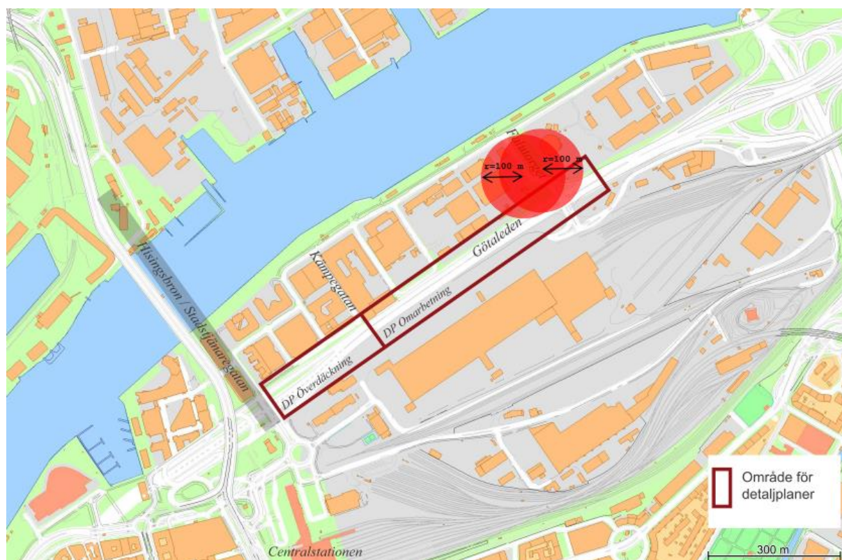
Figur 12. Skyddsavstånd om 100 meter gäller mellan tankstationer för fordonsgas och svårutrymd lokal.
