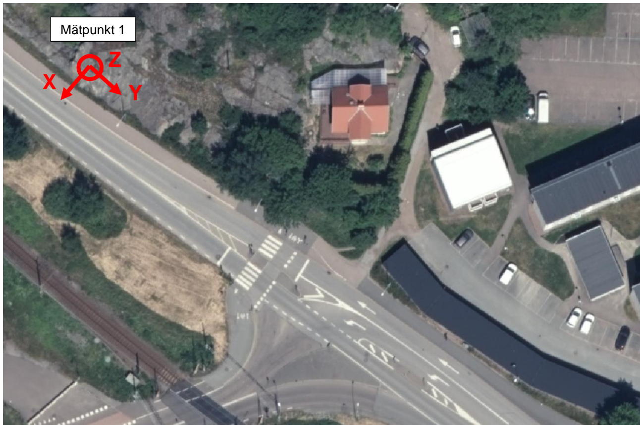
Figur 1: Kartbild över järnvägsövergång tvärs Västra Magårdsvägen. Mätpunkter för mätning av markvibrationer i på berg är markerad och koordinatsystem angivet. Kartbild hämtad från Lantmäteriet, 2023.
