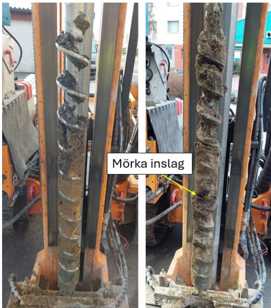
Figur 10. Fotot t.v. visar skr AF18 från djupet 0-1 m som bestod av asfalt sedan fyllnads grusig sandig sten, sedan fyllnadsmassor och detta ovan lera. Fotot t.h. visar skr AF14 från djupet 1-2 m, som bestod av sandiga fyllnadsmassor 0,5-1,6 m sedan naturlig sand ovan lera.
