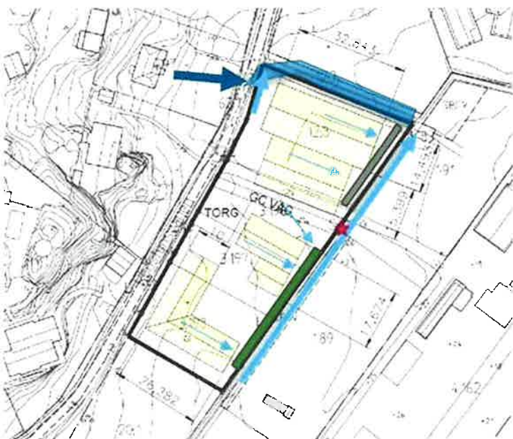
Figur 22. Bild från utredningen för dagvatten och skyfallshantering (20-06-29) som bilagts planförslaget. Bilden visar hur stående vatten skall kunna passera planområdets nordvästra hörn och hur dagvatten ska ledas mot öster över planområdet för att där fördröjas och renas.
