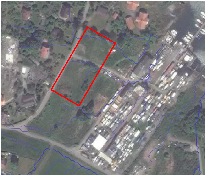
Figur 4 visar naturgivna förutsättningar för ytlig avrinning (blå linjer) enligt befintliga förhållanden.
