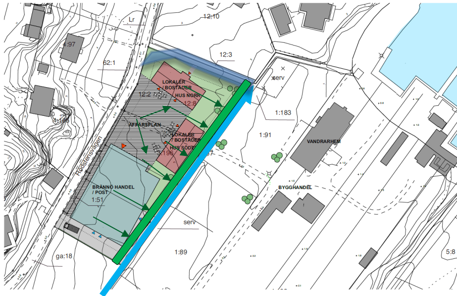
Figur 8 Gröna pilar illustrerar ytlig avledning av dagvattnet till en översilningsyta markerad i grönt. Ljusblå pil visar befintligt samfällighetsdike. Blå yta i norr visar ett ungefärligt stråk som behöver sänkas för att skyfall på ett säkert sätt ska ledas runt bebyggelsen.
