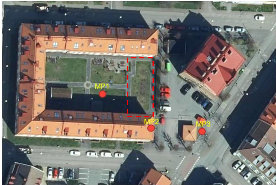
Figur 2. Mätpunktskarta. Röda punkter visar placering av vibrationsmätpunkter, rött streckat område visar placering av kommande byggnad.
