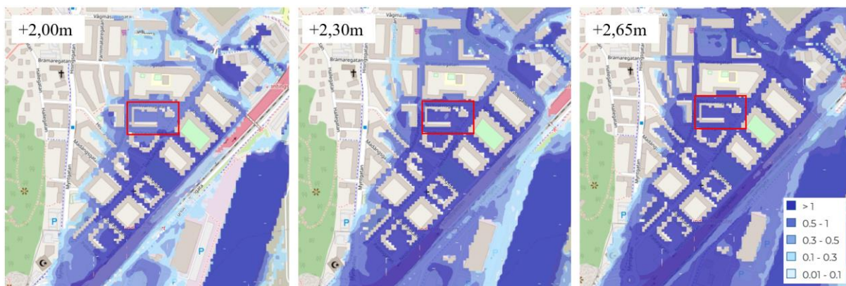
Figur 13 Bilden visar hur högvattennivå i Göta Älv och höga flöden i Kvillebäcken översvämmar området.
