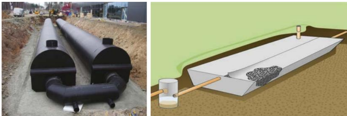
Figur 10. Rörmagasin till vänster och makadammagasin till höger. Illustration från Uponor.
