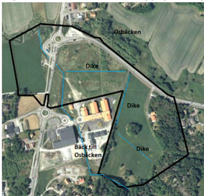
Figur 4 Översikt över befintlig ytlig avvattning
