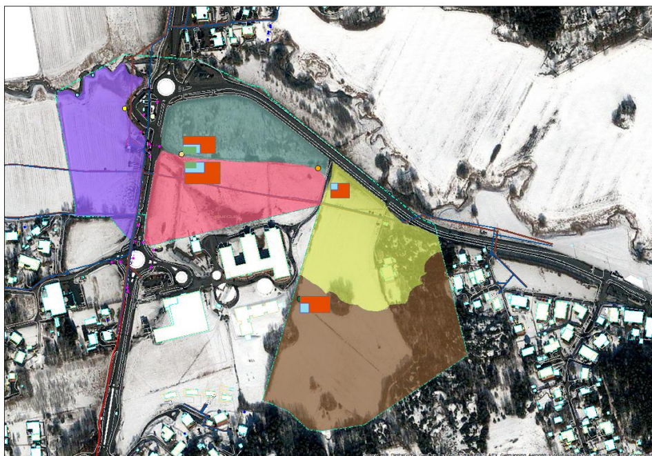
Figur 11. Schematisk bild över ytbehov för översvännings/fördröjningsytor inom delområdena, där grön ruta motsvarar 10-årsregn, blå ruta motsvarar 20-årsregn samt Röd ruta motsvarar 100-års regn.
