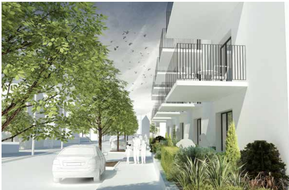
Bilden illustrerar byggnaderna på Lokalgata 3 och den något upphöjda förträdgårdsmarken som frontar bebyggelsen. Upphöjd förträdgårdsmark minskar insyn och tydliggör gränsen mellan gata och bostad.
