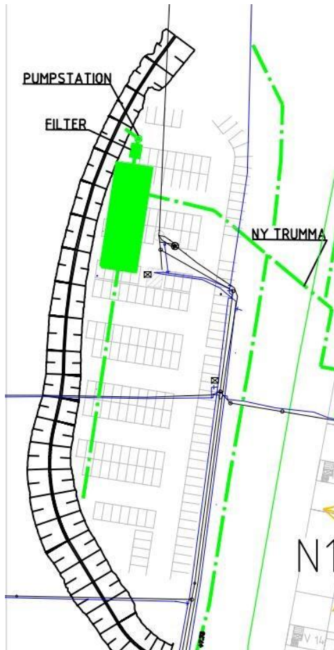
Figur 11: Principskiss över dagvattenhantering med kassettmagasin.
