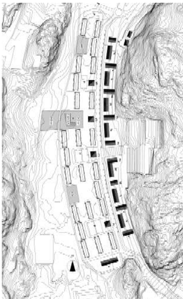
Figur 2. Tidig illustrations skiss till detaljplan. Vita byggnader = befintlig bebyggelse. Svarta byggnader = föreslagen bebyggelse
