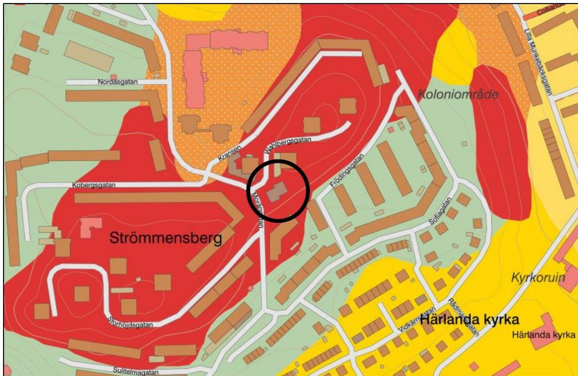
Figur 14: SGU:s jordartskarta. Rött område visar läge för berg i dagen. Orange-markerat område visar läge för sand. Grönt område visar läge för morän omväxlat med sorterade material. Gult område visar läge för lera
