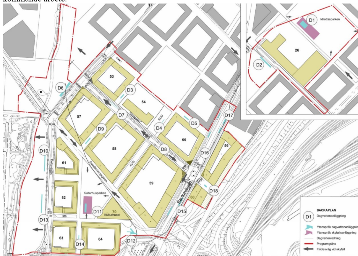
Figur 1 Föreslagen dagvatten- och skyfallshantering i allmän platsmark. Se även Bilaga 1.
