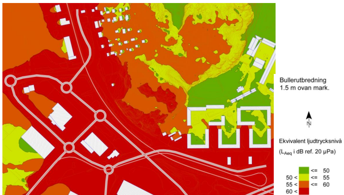
Framtida bullersituation, Väg-, spår- och tågtrafik utan bulleråtgärder. Bild: Akustikforum.
