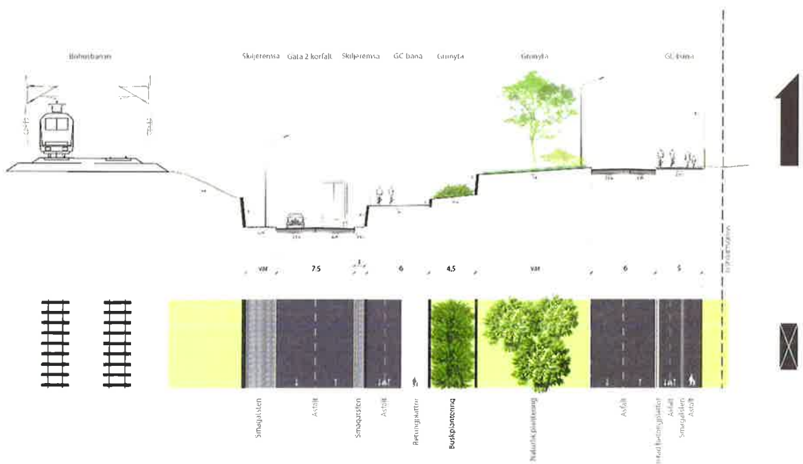
Sektion F-F (Se planillustration ovan) . Sektion för nya Lillhagsvägen, sett mot norr på väg från port under Bohusbanan. Bild Trafikkontoret/COWI.
